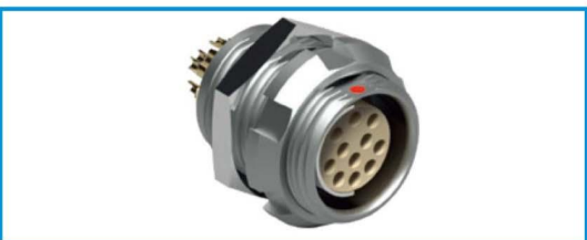
ZYN 真空密封短款插座, 外螺母固定, 内部半圆金属片定位, 防止误插, 防水 (IP68)
