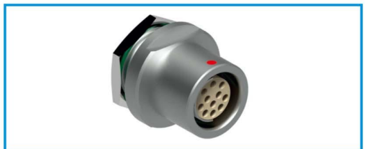
ZHN 凸出式尾部内螺母固定插座, 内螺母固定 (前面板安装), 内部半圆金属片定位, 防止误插, 防水 (IP68)
